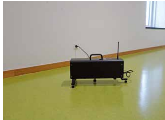
Messung des Trittschalls mit Normhammerwerk
